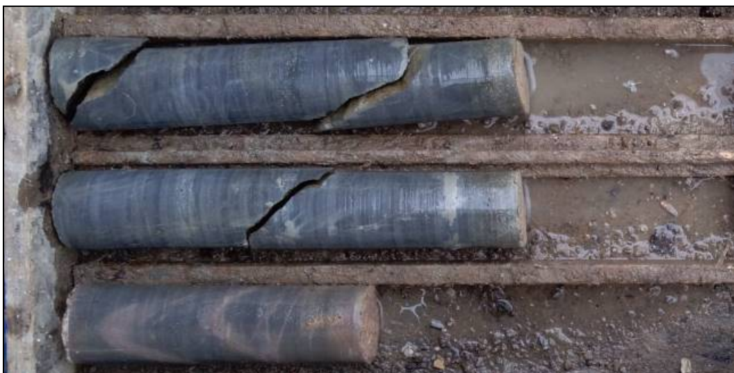
Obr. č. 2 - diagnostický návrť N2 – N4 do klenby
