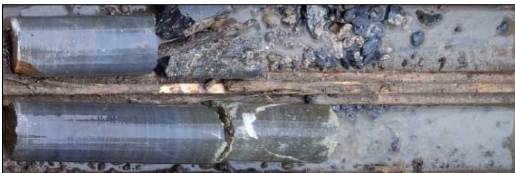
Obr. č. 3 - diagnostický návrť N5 – N6 do klenby
